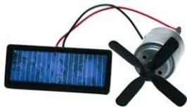
Der Motor dreht sich, die Solarzelle hat **elektrische Energie bereit** gestellt.
