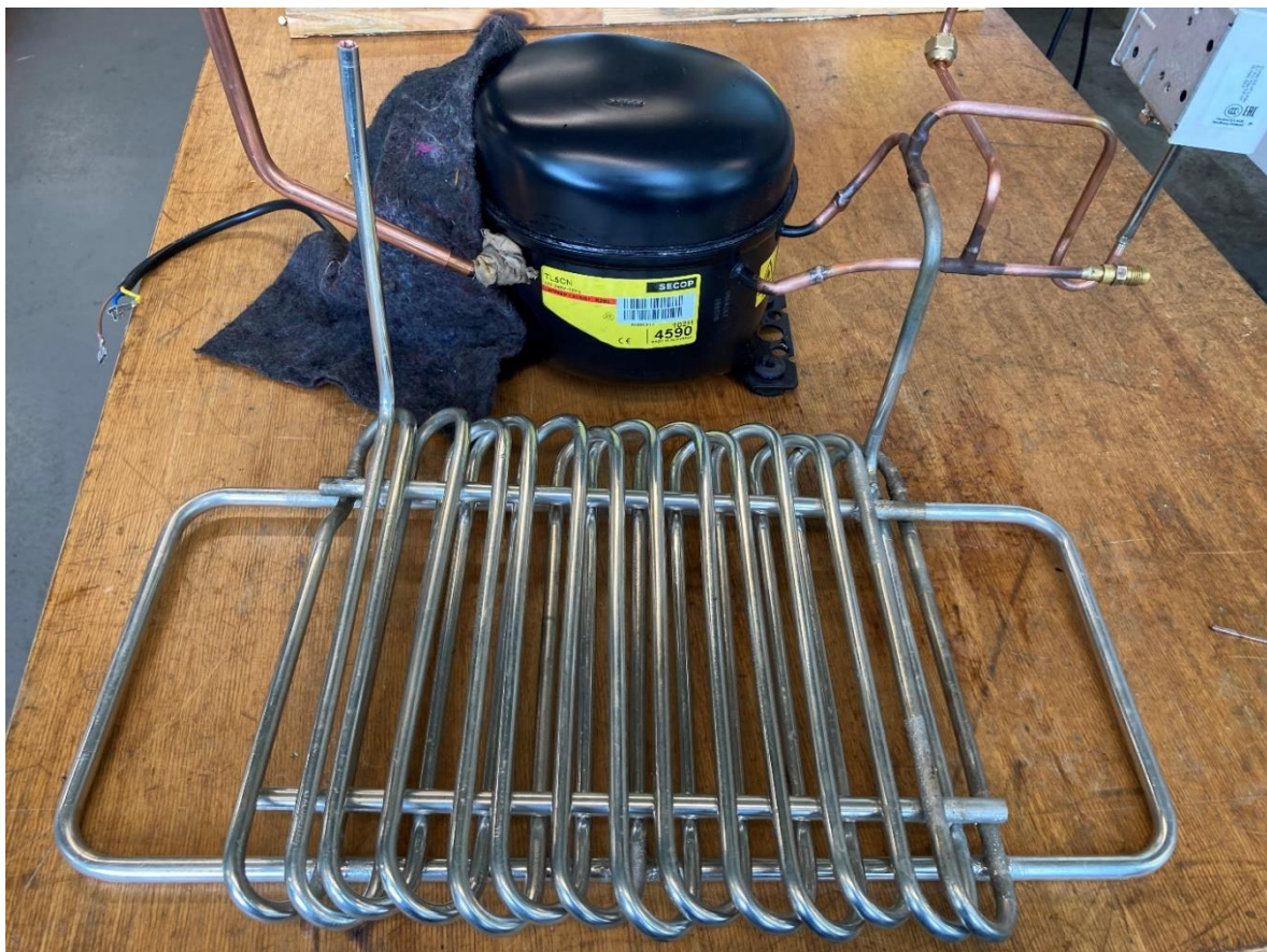
Bild 2: Verzinnter Verflüssiger mit dem Verdichter verlötet
