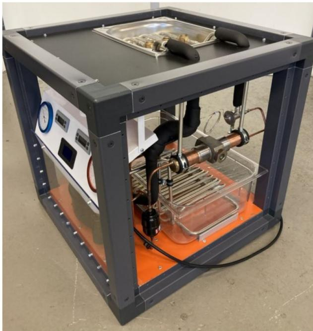
So sieht das Aggregat (Kältemaschine/Wärmepumpe mit Warm- und Kaltwasser) aus.
